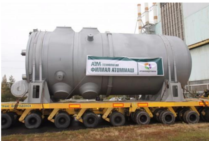
Корпус реактора для 2-го блока Белорусской АЭС
