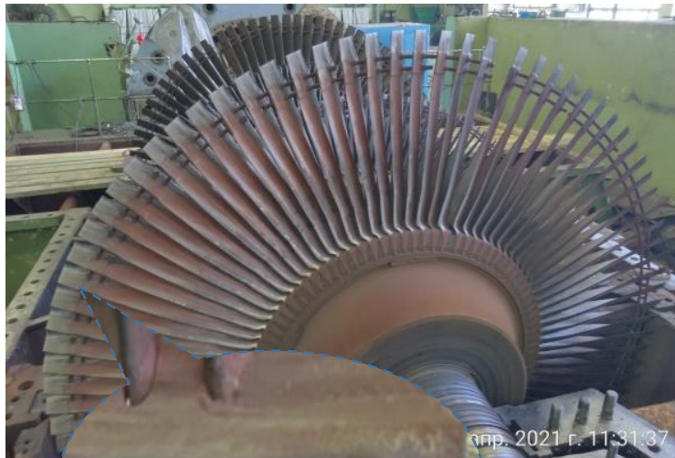
Дефектация лопаток РНД
