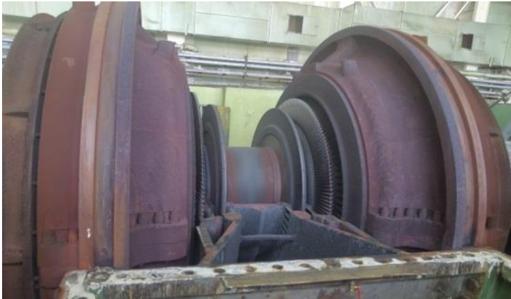
Дефектация лопаток РНД
