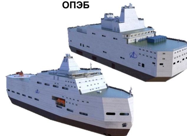
ОПЭБ с двумя РУ РИТМ-200М
