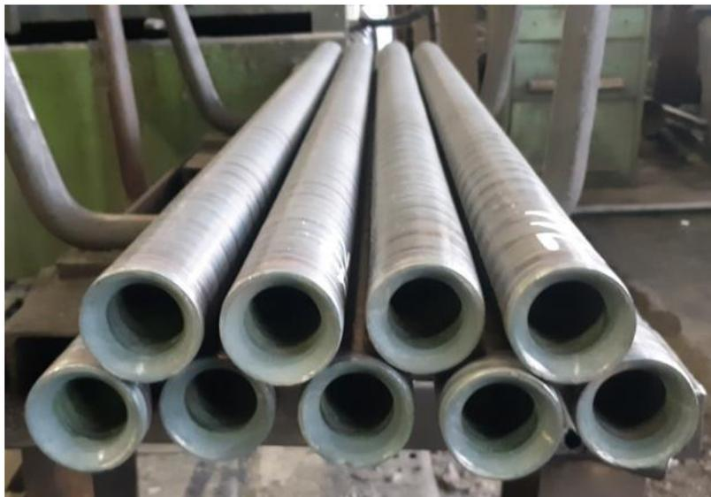
Характерный внешний вид трубных гильз-заготовок из сплава 42ХНМ, полученных методом поперечно-винтовой прошивки
