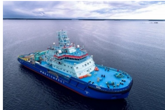
ПОРТОВЫЙ ЛЕДОКОЛ ПРОЕКТА AKER ARC 124 «ОБЬ», МОЩНОСТЬ 12 МВТ
