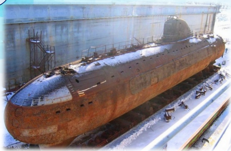
ВНЕШНИЙ ВИД К-3 ПОСЛЕ ПОСТАНОВКИ В ПЛАВУЧИЙ ДОК
