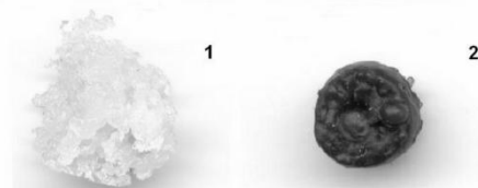
Повышение огнестойкости за счет изменения механизма горения
