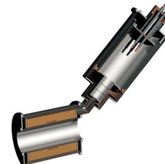
Магнитная установка МАГДА (исследования МГД эффектов в жидких металлах)
