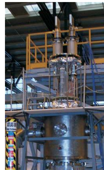
Токовводы с током 24 кА
