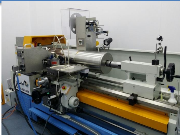
Установка механической полировки
